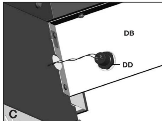
b. Connectez les deux fils d'allumage au bouton d'allumeur Multi Spark™ (DD), comme indiqué dans la figure C.
