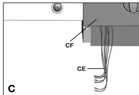
**CONSEIL :** Les fils de l'ensemble d'électrode du brûleur principale (CE) du brûleur latéral, et du Multi Spark™ peuvent être trouvé attaché à l'écran thermique du panneau de control (CF) comme illustré.
