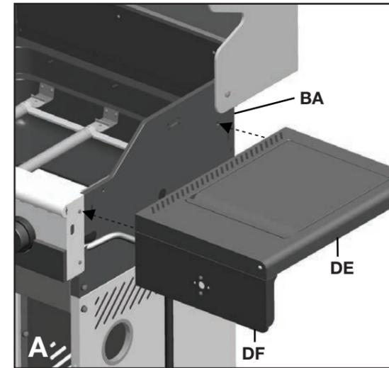
a. Ouvrez le couvercle. Assemblez la tablette latérale droite (DE et DF) à l'assemblage du chariot en insérant les onglets sur la tablette latérale dans les trous de l'assemblage du chariot, comme le montre la figure A.
