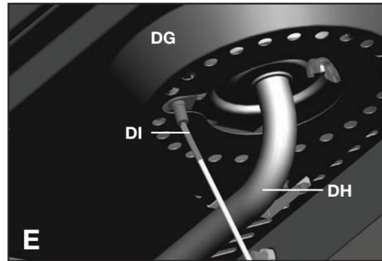
d. Attachez l'extrémité du fil à électrode du brûleur latéral (DI) à la partie inférieure de l'électrode du brûleur latéral (DH), tel qu'indiqué sur le schéma E. Assurez-vous que le fil est correctement enfoncé.
