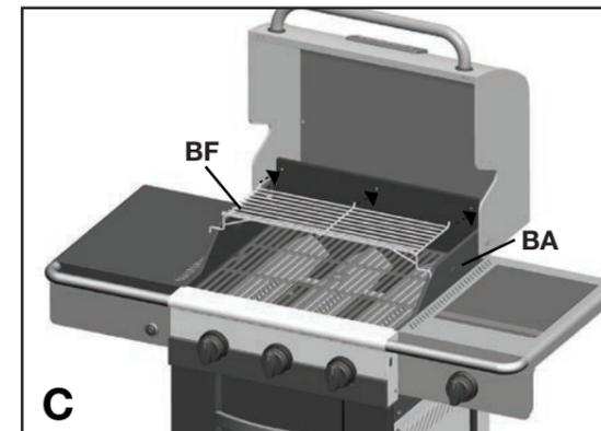
a. Positionnez d'abord les brise-flammes (BD) dans le compartiment des brûleurs (BA).
